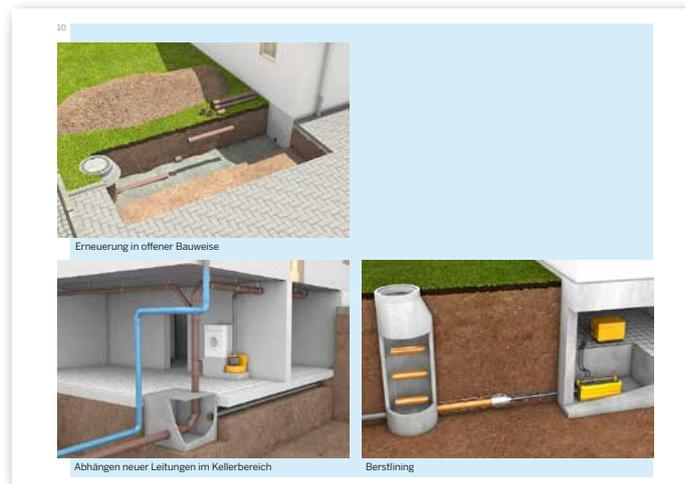
**Bild 3: Faltblatt „Sanierung privater Abwasserleitungen“, Bildbeispiele zur Erneuerung**
